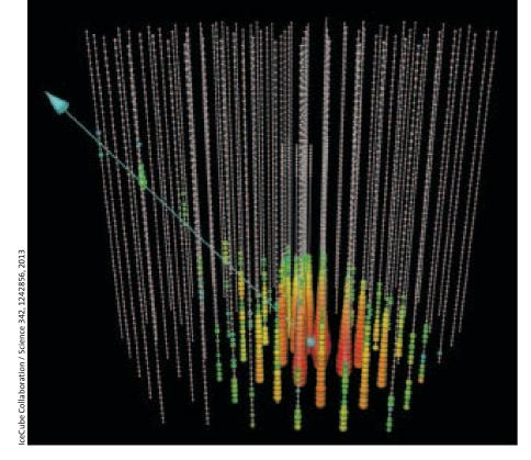
Die Wechselwirkung eines Neutrinos mit einem Molekül des antarktischen Eises erzeugt einen Teilchenschauer, der im Detektor IceCube zahlreiche der an Trossen aufgehängten Photomultiplier ansprechen lässt (farbige Kugeln). Das nach links oben wegfliegende Myon (Pfeil) setzt die Spur des ursprünglichen Neutrinos fort und zeigt somit dessen Flugrichtung an.
