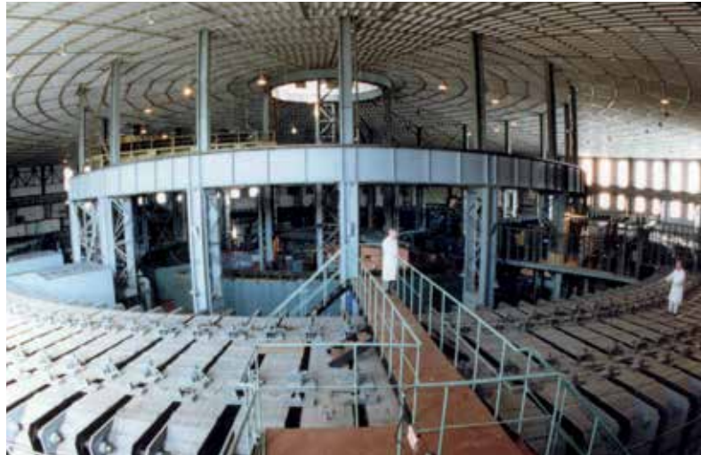
Abb. 3 Das Synchrotron beschleunigte Protonen auf Energien bis zu 10 GeV. Der Betrieb wurde 2003 eingestellt – hier entstehen die Vorbeschleuniger von NICA.
