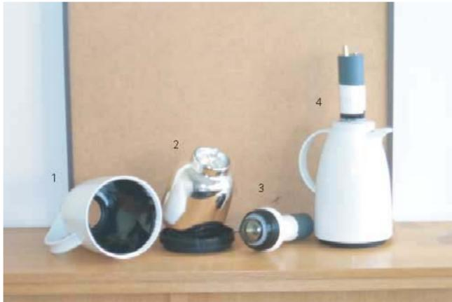
ABB. 1: Wasser-Čerenkov-Detektor 1: Verkleidung; 2: Wasserbehälter; 3: Photomultiplier im Schraubverschluss; 4: kompletter Detektor
