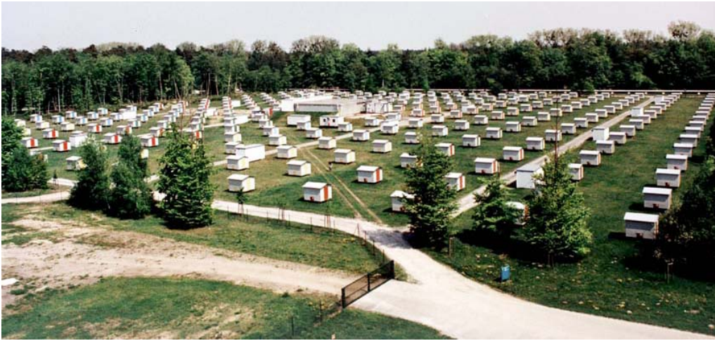
Abbildung 3.35: Das KASCADE-Experiment im Forschungszentrum Karlsruhe. Erkennbar sind neben den einzelnen Hütten des Detektorfelds auch der in der Mitte gelegene Zentraldetektor.
