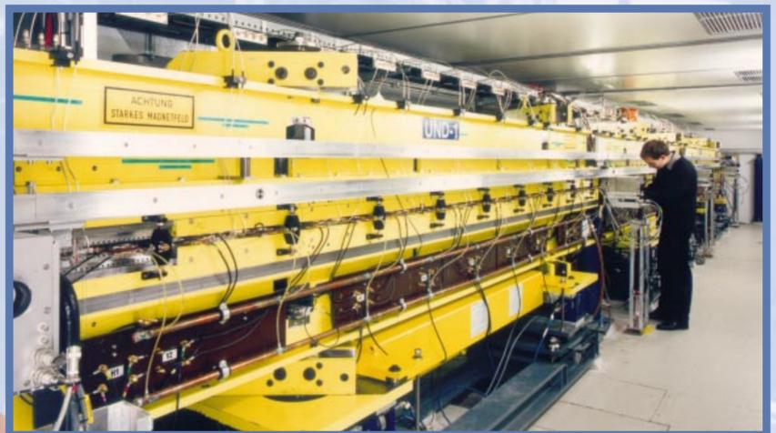
In diesem „Undulator“, einer besonderen Magnetanordnung, werden die beschleunigten Elektronen auf einen Slalomkurs gebracht. Dabei senden sie Laserlichtblitze aus.
