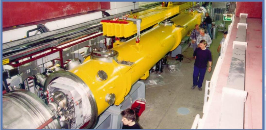
Ein supraleitendes Beschleunigungsmodul wird in die TESLA-Testanlage eingebaut.
