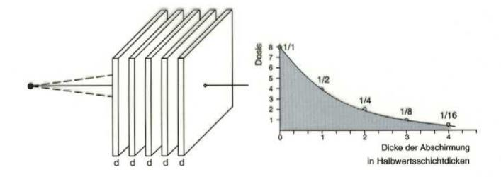
Die Dosis nimmt bei Gammastrahlung mit der Dicke der Abschirmschicht d exponentiell ab:
